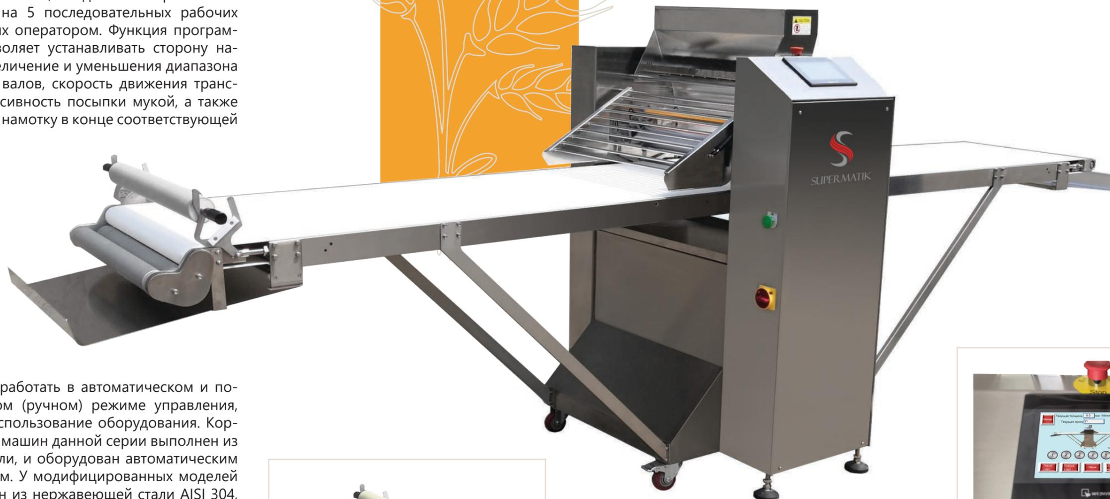
Машина может работать в автоматическом и полуавтоматическом (ручном) режиме управления, что облегчает использование оборудования. Корпус стандартных машин данной серии выполнен из окрашенной стали, и оборудован автоматическим мукопосыпателем. У модифицированных моделей корпус выполнен из нержавеющей стали AISI 304, также опционально может устанавливаться автоматическое наматывающее устройство для теста.
